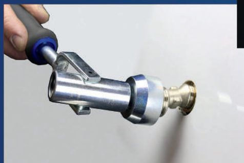
Ein- und Ausschrauben von 3/4" - S- Anschlüssen.
